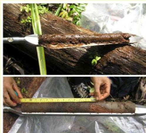
Gambar 2. Contoh tanah gambut yang diambil menggunakan bor gambut (peat sampler). Gambar atas memperlihatkan contoh gambut fibrik (mentah) dan gambar bawah contoh gambut hemik (setengah matang).
