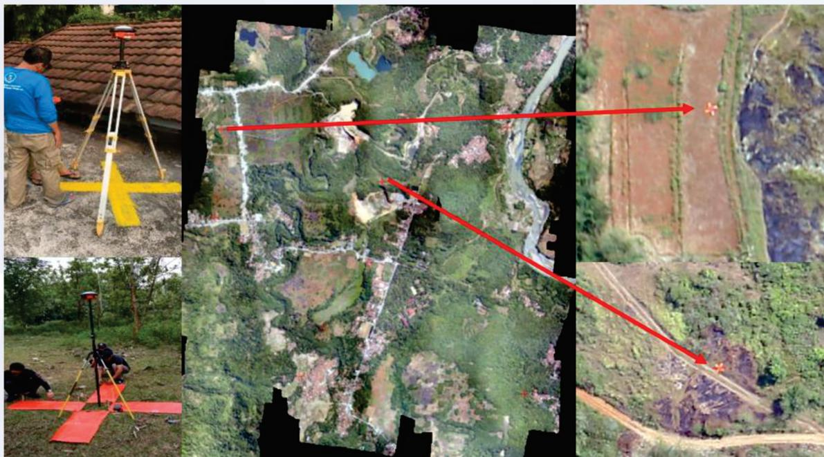
Gambar 5. Contoh pemasangan titik sampel GCP untuk meningkatkan akurasi posisi foto udara
