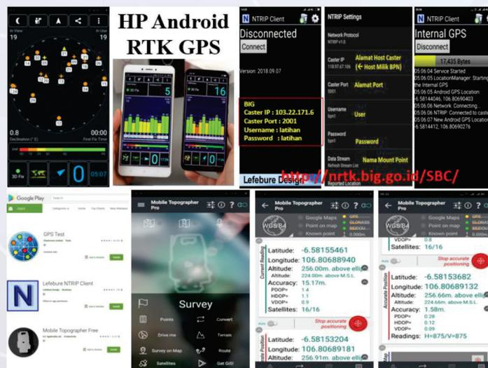
Gambar 8. Aplikasi yang digunakan untuk mendapatkan posisi dengan metode RTK menggunakan smartphone.
