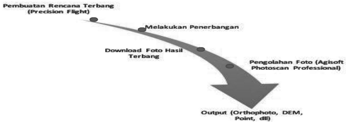
Gambar. Alur Pengambilan Citra Menggunakan Drone Multirotor (DJI Phantom 3 Advanced)
