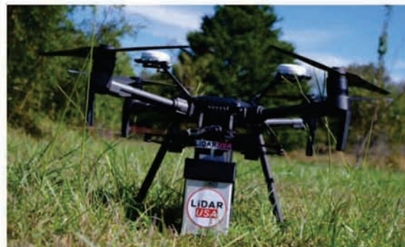
Gambar 5. Teknologi LiDAR yang sudah mampu diaplikasikan menggunakan UAV
