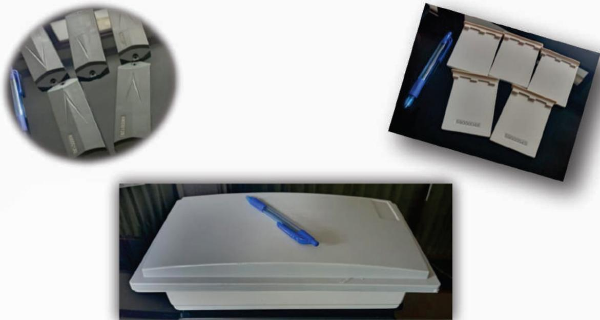
Gambar 2. Tag RfId aktif (atas), dan Reader RfId (bawah). (Sumber foto: penulis)
