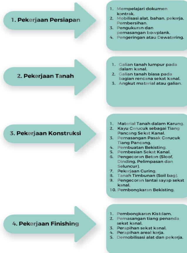
**GAMBAR 37** | Tahapan dan Jenis Pekerjaan Konstruksi Sekat Kanal Beton
