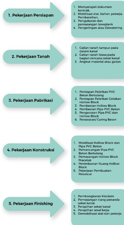
**GAMBAR 76** | Tahapan dan Jenis Pekerjaan Konstruksi Sekat Kanal Hollow block Pra-Cetak
