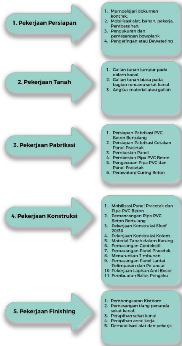
**GAMBAR 53** | Tahapan dan Jenis Pekerjaan Konstruksi Sekat Kanal Panel Pra-Cetak
