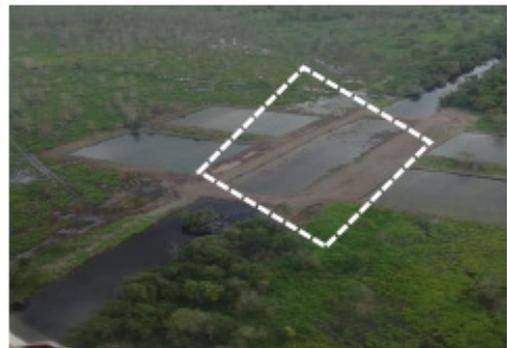
**GAMBAR 100** | Timbun kanal dengan kondisi rusak ringan membutuhkan perawatan dan pemeliharaan ringan
